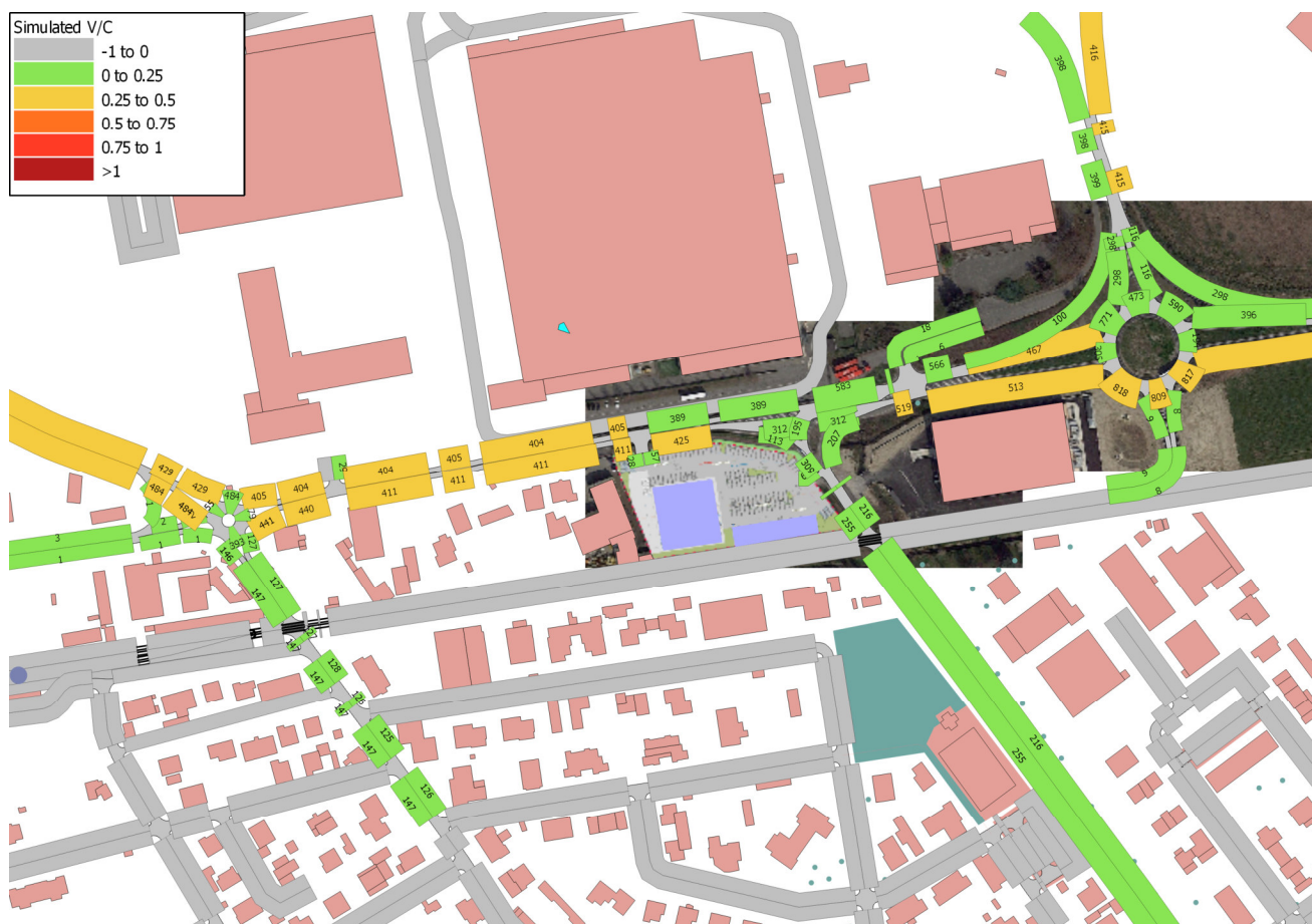
Figura 37 – Scenario di progetto: flussogramma rete stradale area di studio
