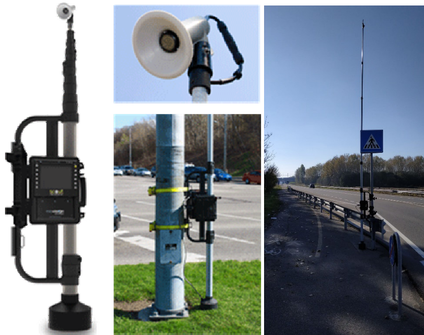
Figura 12 – Strumentazione video con palo telescopico
