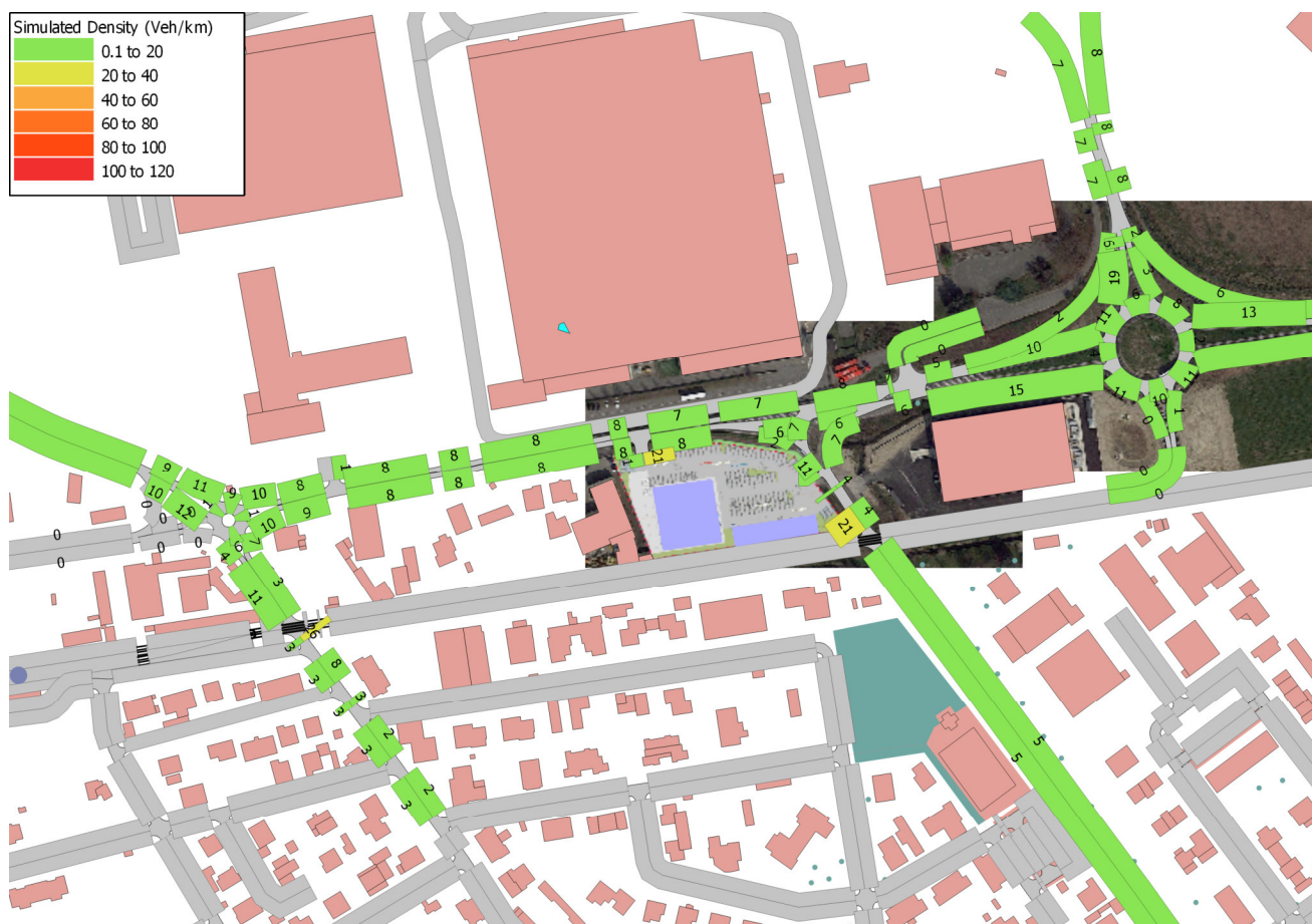
Figura 41 – Scenario di progetto: densità media veicolare rete stradale area di studio
